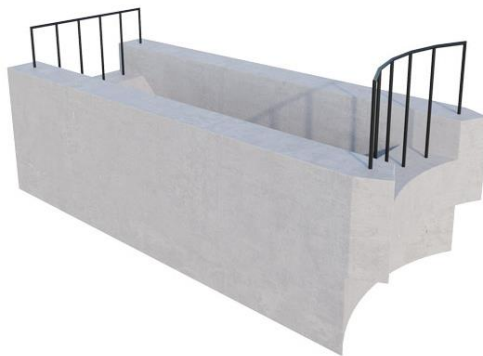
Fot. 1 Przykładowa wizualizacja osadnika przed studnią wpadową (na zakończeniu rowu projektowanego).
